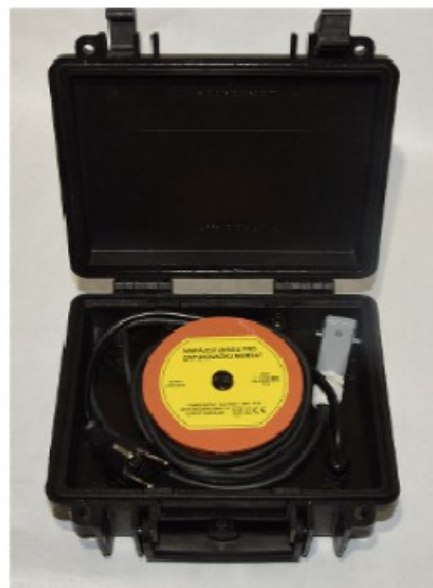
Zdroj 230AC/24VDC, 6A Knoflík pod rukojetí slouží k odstranění podtlaku před otevřením
